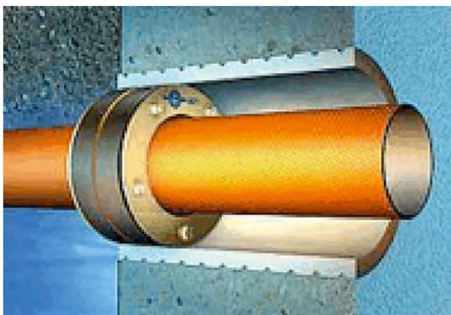
Abb. 7: Schemaskizze Ringraumdichtung, Quelle: Doyma GmbH & Co. KG
