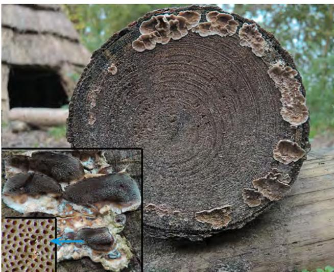
**Abb. 29:** Balancierbalken: Fruchtkörper des Blutenden Schichtpilzes (*Stereum sanguinolentum*) an einem Rundholz; Kernholz ohne Befall; Eckbild: Verwechslungsgefahr mit einigen z. T. flach anliegenden Porlingen [kleines Eckbild zeigt die feinen Poren], wie dem Angebrannten Rauchporling (*Bjerkandera adusta*).
