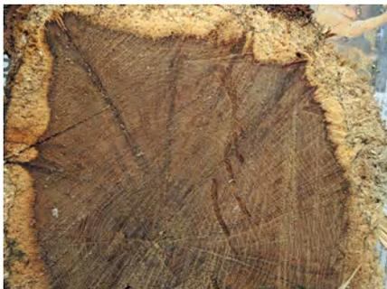
**Abb. 27:** Eiche mit Weißfäule am Splintholz durch den Zotteligen Schillerporling (*Inonotus hispidus*); Kernholz ohne augenscheinlich erkennbaren Befall; der Verlauf der Kernholzgrenze ist unregelmäßig; Bauteildurchmesser: ca. 25 cm.
