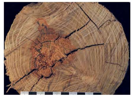
**Abb. 38:** Ausnahme an einem Pfeiler (ggf. Vorschaden durch Lagerfehler): Innenfäule durch den Großporigen Feuerschwamm (*Phellinus contiguus*); die faserige, helle Weißfäule begann im Mark und breitete sich im Kernholz aus.
