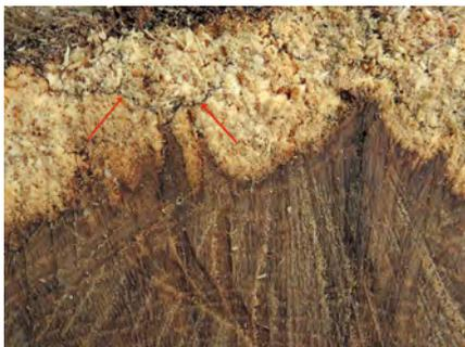
**Abb. 28:** Zotteliger Schillerporling (*Inonotus hispidus*) – ein Pilz mit nur schwacher Fähigkeit zum Kernholzangriff; deutlicher Übergang vom Kern zum Splintholz (oben); Weißfäule nur im Splintholz; im Kernholz ist kein sichtbarer Schaden vorhanden (Detail von Abb. 27); Holz mit feinen Demarkationslinien (Pfeil).
