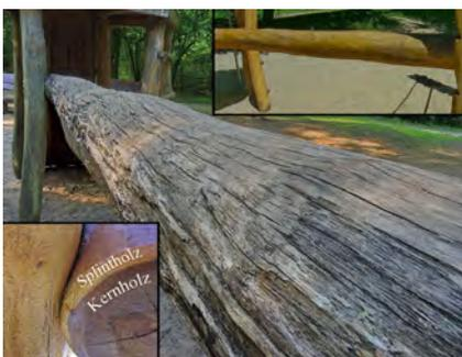
**Abb. 36:** Balancierbalken aus Robinienholz, ehemals mit Splint: Das weißfaule Splintholz wurde auf der Oberseite abgespielt, fast nur das Kernholz ist übriggeblieben; Spielgerät 14 Jahre alt. (Hinweis: Es sind keine Robinien in der Nähe dieses Spielplatzes und daher sind spezialisierte Zerstörer von Robinienkernholz im Umfeld mutmaßlich seltener<sup>1</sup>); Eckbilder: Neubauzustand nach wenigen Wochen.
