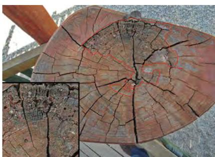
**Abb. 42:** Robinie: im Prinzip eine geeignete Holzart, aber hier mit einer Stammfäule – es liegt eine streifige Weißfäule vor; die rote Linie grenzt den, nach dem Augenschein erkennbaren, Befallsbereich ein; Eckbild: Detail des faserigen Abbaus, zudem Insektschaden; frühe Folgeschäden sind wahrscheinlich.
