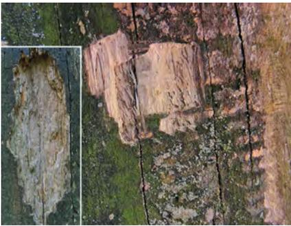
**Abb. 35:** Fleischroter Zystidenrindenpilz (*Peniophora incarnata*) mit nur schwacher Fähigkeit zum Kernholzangriff: Probe-Anstich des weißfaulen Robinienholz Pfahls – die unterliegenden Schichten sind noch fest; bisher ist nur das Splintholz befallen; Eckbild: 11 Jahre später, der Weißfäuleschaden hat sich vergrößert, aber nur wenig vertieft.
